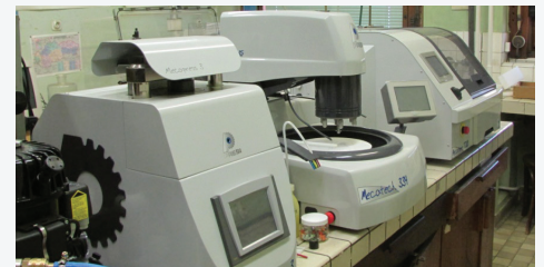
Píla, lis na zalievanie a leštička na úpravu vzoriek
